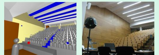
Figura 4 - Modellizzazione della sala (sinistra), collaudo in opera a lavori ultimati (destra)
